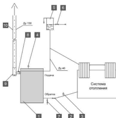
б) Открытая система с самоточной циркуляцией
