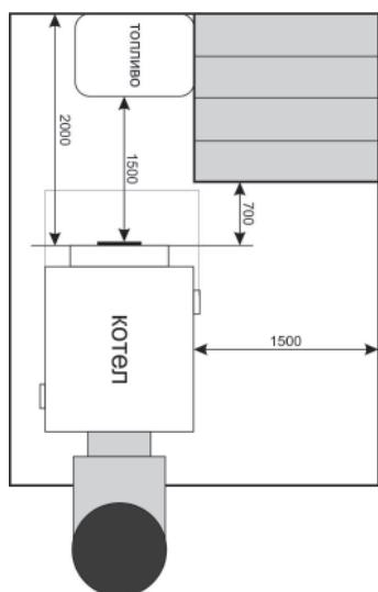
Установка котла, монтаж дымовой трубы и системы отопления должны производиться в соответствии с «Правилами устройства и безопасной эксплуатации паровых котлов с давлением пара не более 0,07 МПа (0,7кг/см<sup>2</sup>), водогрейных котлов и водонагревателей с температурой нагрева воды не выше 338 К (115°C)».
