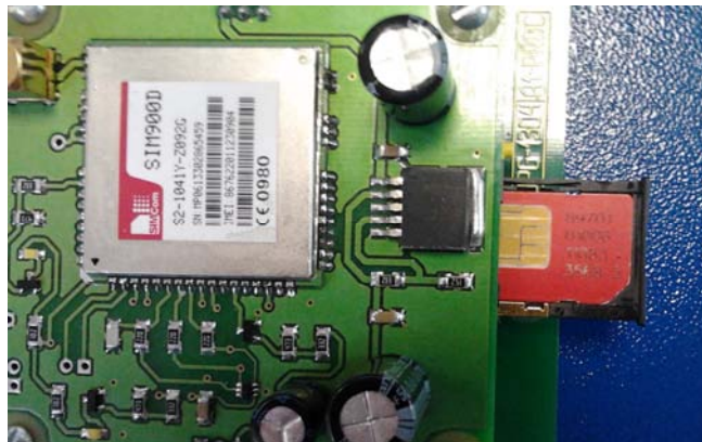
Фото 16.1. Установка лотка на место
